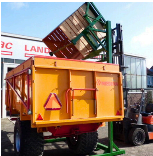
mechanische kantelaar wordt gekanteld m.b.v. een heftruck
